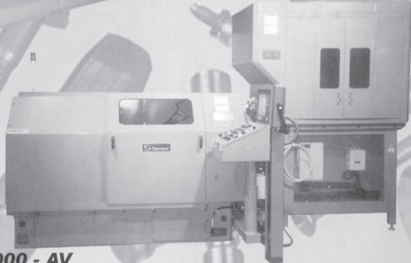
THI-R2000 - AV Thread Roller / Washer Assembly Unit
